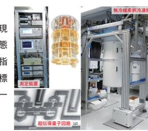
超伝導量子回路に発現する量子力学特有の状態を自在に扱うことを目指しています。究極の目標は超伝導量子コンピュータの実現です。
